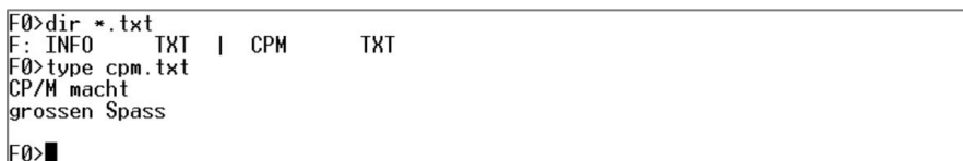
Abbildung 19 - Das Anzeigen des Datei-Inhaltes mittels TYPE
