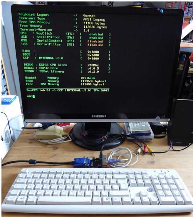
Abbildung 97 - Das TTGO-VGA32-Board am Monitor und mit PS/2-Tastatur
